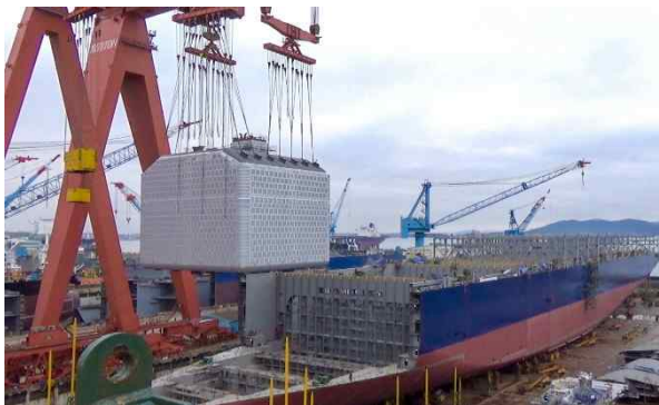
그림 1: 개방 갑판 아래에 설치된 Type B 연료 탱크
